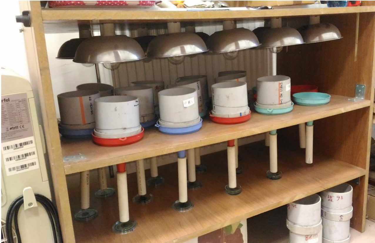
Şekil 2: Laboratuvarda toprak örneklerinden eklem bacaklılarının çıkartıldığı modifiye Berlese hunisi.
