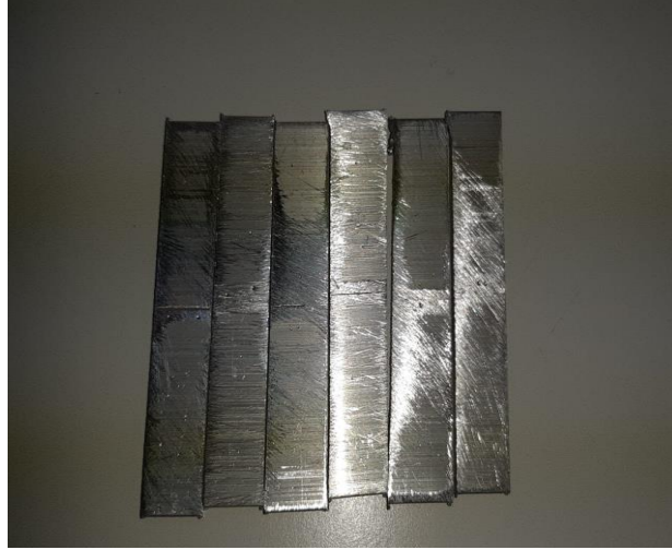
Şekil 6: Kaynaklı parçaların brinell sertlik ölçümü
