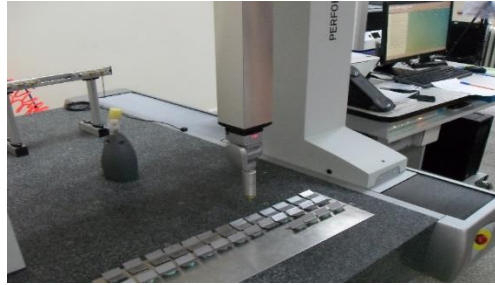
Şekil 3: CMM ile geri esnemenin ölçümü
