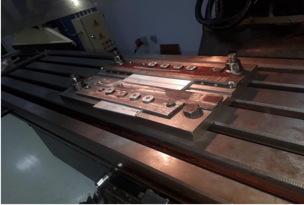
Şekil 1: Kaynak parçalarının kalıba bağlanması
