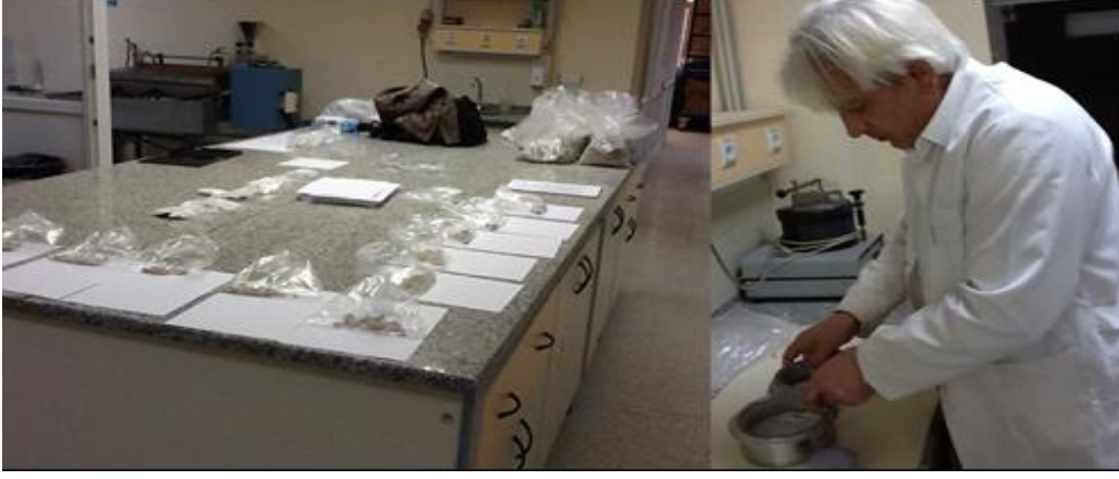
Şekil 3: ICP 50 µm boyutunda numune hazırlama işlemi
