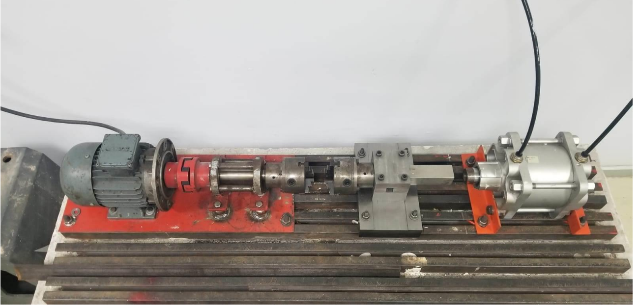
Şekil 5: Montajı tamamlanan sürtünme kaynağı makinası
